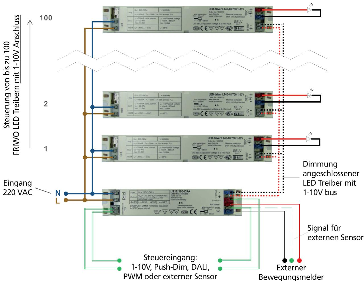
Die Lichtsteuereinheit erzeugt aus dem eingangsseitigen DALI- oder Push-Dim- ein 1- bis 10-V-Signal.
